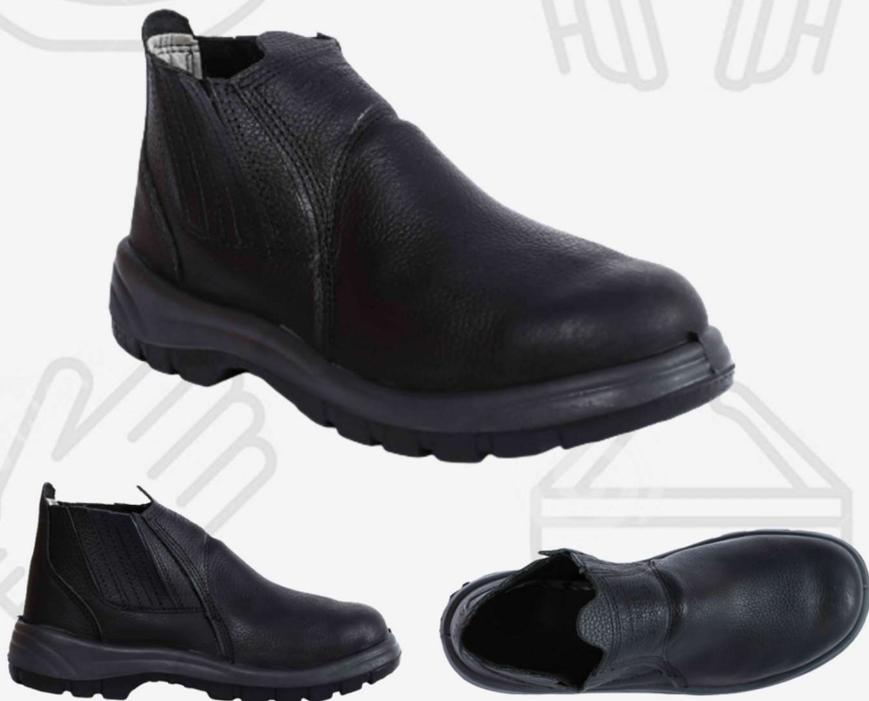
**Solado** Constituído de duas camadas de poliuretano (PU), injetado diretamente no cabedal, sendo a 1ª camada (entressola) mais macia e leve, com densidade de 0,4g/cm<sup>3</sup> proporcionando maior conforto; e 2ª camada (sola) mais compacta com densidade de 1,0 g/cm<sup>3</sup>, resistente a abrasão com sistema antiderrapante constituído de ranhuras especiais de 3mm de altura e 6mm de largura e resistencia ao escorregamento em piso cerâmico e piso de aço (Nível SRC).
